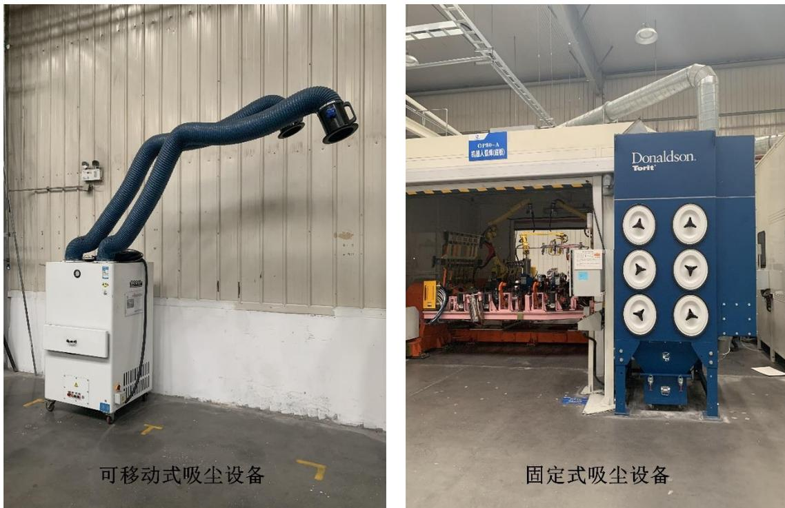
图 3-3 废气处理装置
