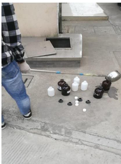
图 3-4 生活污水化粪池采样点照片
